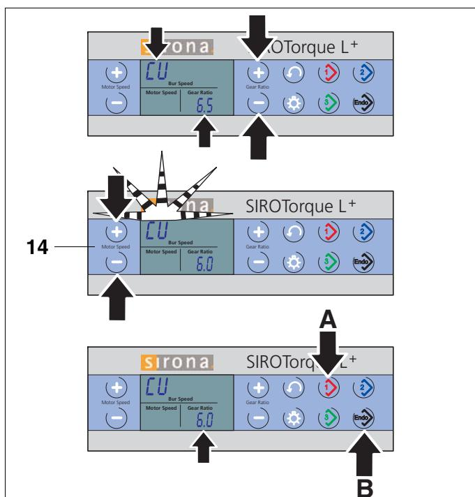
Le couple du moteur électrique peut être modifié si nécessaire.
