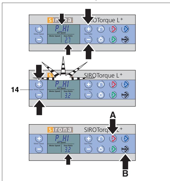
Afin d'utiliser de manière optimale la course de réglage de la pédale de commande pneumatique, il est nécessaire de régler dans ce menu la pression d'air propulseur (en bar) disponible à la sortie du tuyau d'alimentation en air. Si vous souhaitez atteindre la vitesse de rotation maximale préselectionnée avec une course inférieure au débattement complet de la pédale, il est possible de réduire cette pression.
