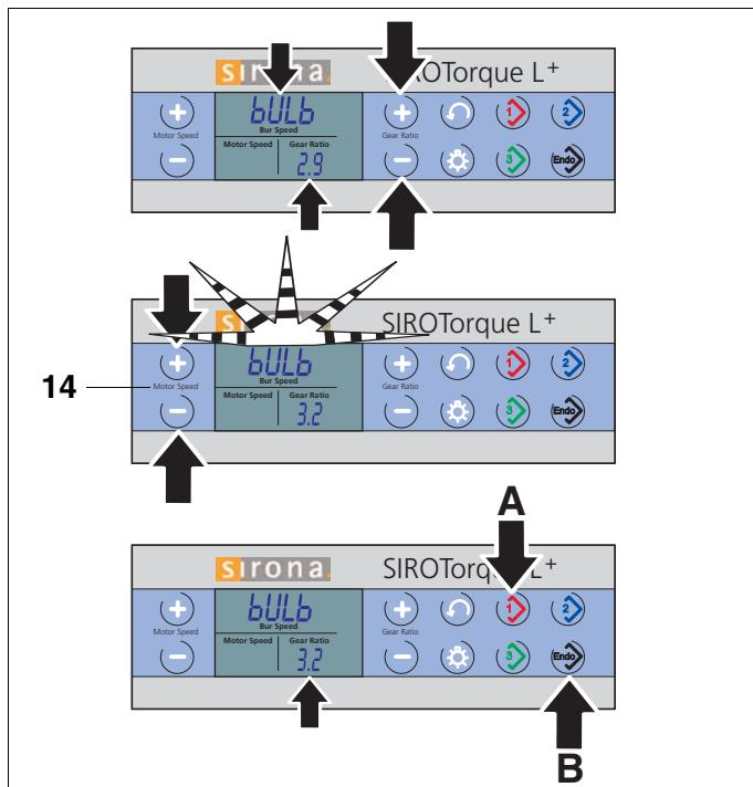
Si l'éclairage de la cavité avec la lumière d'instrument vous semble trop clair ou trop sombre, il est possible d'adapter la tension de la lampe.
